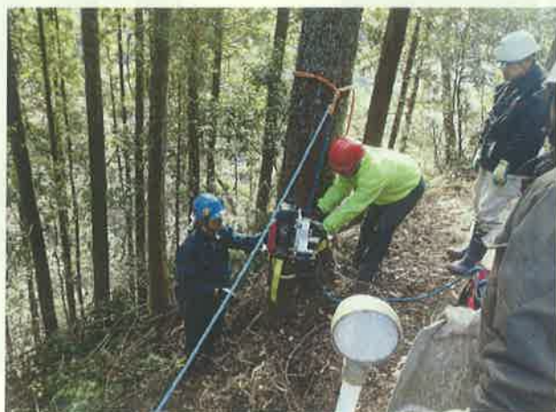
図表 44 ウインチの設置（左）と材の取り付け（右）
