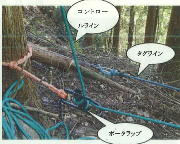
図表 47 搬器部分（左）とポータラップを用いたブレーキ部（左）
