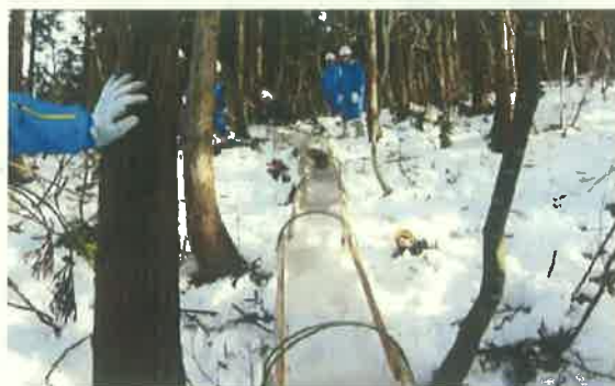
図表 30 横手式簡易集材修羅 iido（左）とロープウインチ集材
