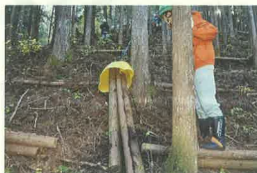
図表 30 横手式簡易集材修羅 iido（左）とロープウインチ集材
