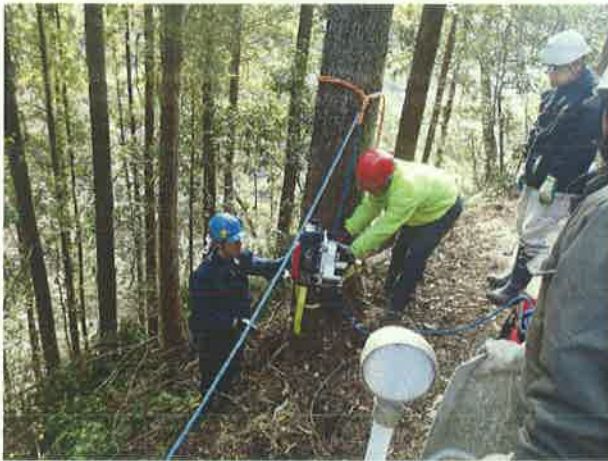
ウインチの設置（左）と材の取り付け（右）
