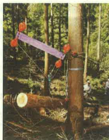
図表 29 スカイウッドシュート（左）と土佐の森救援隊方式軽架線（右）
