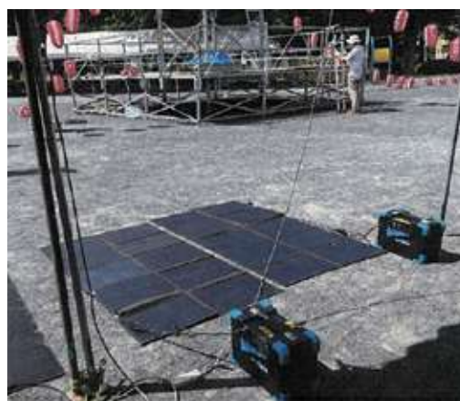
稼働実験の様子。太陽光発電パネルを使い大型蓄電池に充電
